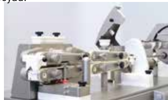
↑ Séparation précise avec solution à 2 bandes et capteur
