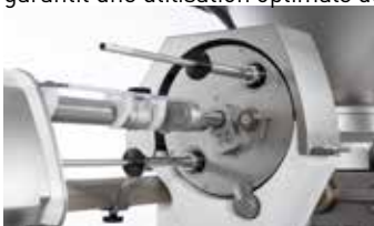
↑ Enfilage de boyau avec fonction de changement de boyau semi-automatique
